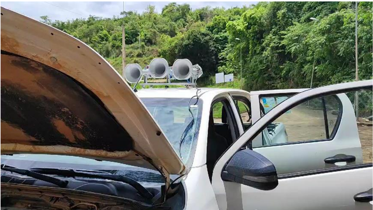
Figura 3-3 – Vista do Sistema Móvel de Notificação Instalada em caminhonete da HCSA.
